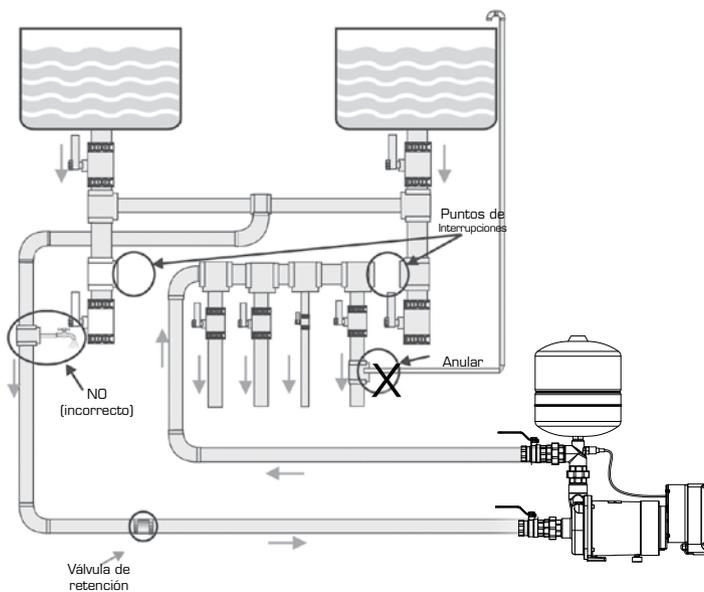
PRESS VF con variador de frecuencia
