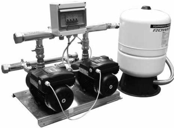
La nueva serie de grupos de presurización con velocidad variable VARIO 1-20 representa una solución fiable y de fácil empleo para aplicaciones residenciales y comerciales. El sistema cuenta con la instalación en paralelo de dos inversores integrados directamente en el motor de cada electrobomba instalada. Los dos convertidores de frecuencia comunican y alternan el orden de arranque de cada ciclo de trabajo manteniendo siempre la presión constante en el sistema de distribución.
