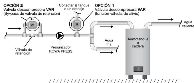
En este caso en particular (opción1) la válvula se deberá instalar en forma VERTICAL y a la salida de la misma se colocará un tubo de aproximadamente 15 cm, el cual se deberá conectar a un drenaje externo.
